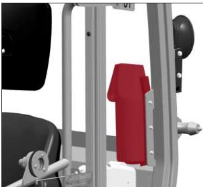
Abb. 3: Montageplatz für den Feuerlöscher
